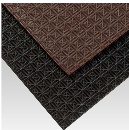
700 019 50 transparentbraun / trans. brown 700 020 50 schwarz / black Contol Kletter klein Spezialgummi, öl- und benzinbeständig (Farbe schwarz ist antistatisch), Größe 80 x 100 cm, Stärke 5 mm Contol Kletter small special rubber, oil and petrol resistant (colour black is anti-static), size 32 x 40 inches, thickness 10 iron
