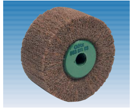
863 811 03 Scotch-Bodenrolle grün, 100 x 50 mm, M 16 links, fester Schleifvlies, geeignet für Schuhboden- bearbeitung, z.B. Zwickeinschlag glätten
